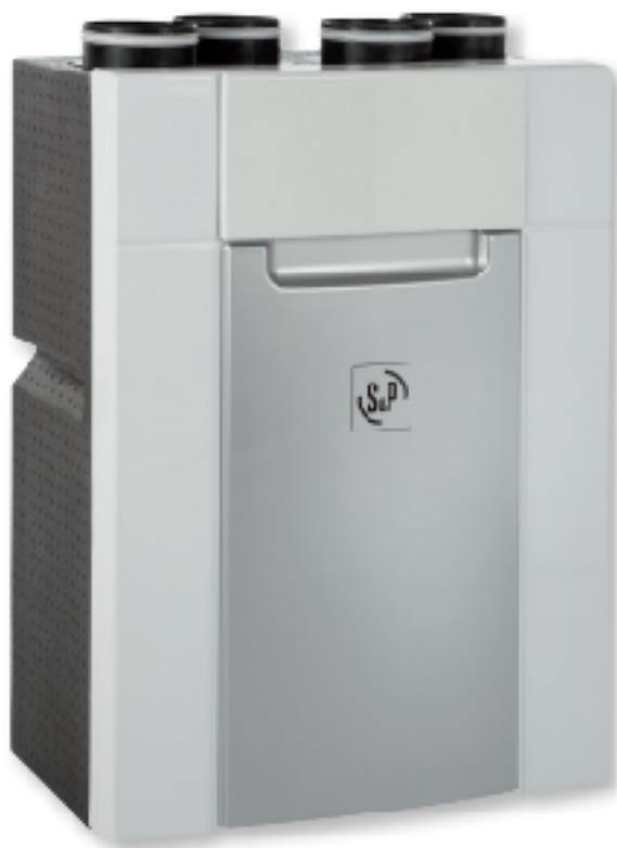
VMC de doble flujo, para viviendas unifamiliares, con intercambiador de calor de tipo contraflujo de alto rendimiento (hasta el 92%) y motor EC de corriente continua, de muy bajo consumo. Asegura la renovación permanente de aire de las viviendas unifamiliares, y garantiza los requisitos requeridos en el Código Técnico de Edificación.
